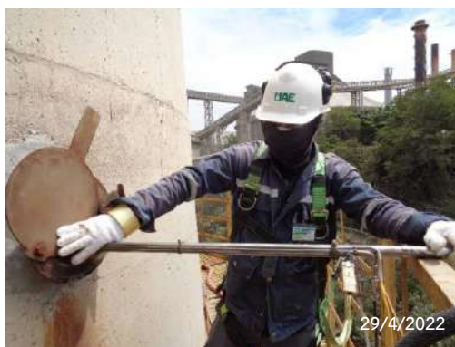
รูปที่ 3-12 การตรวจวัดคุณภาพอากาศ จากปล่องระบายของ RDF 60 MW
